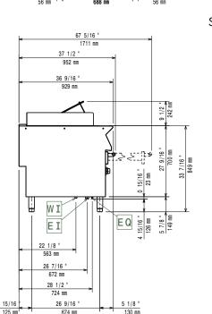
Electrical inlet (power) Equipotential screw
